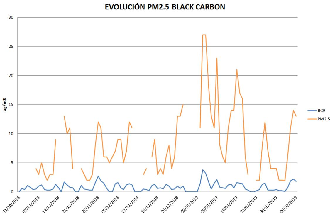
Gráfico 9: Evolución de los valores medios diarios de PM<sub>2,5</sub> con longitud de onda del canal bc9 (µg/m<sup>3</sup>) en la estación de Arco Ladrillo II y LDR.
